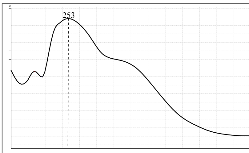
Рисунок 2 – УФ спектр ВКВ-1 в элюенте ацетонитрил – 0,1% раствор кислоты трифторуксусной
