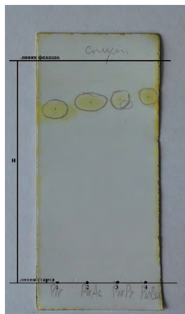
Рисунок 2 – Хроматографическая пластинка с опыта №2 после трехминутного выдерживания в йодной камере
