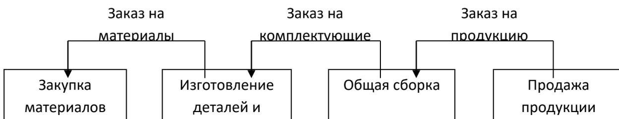
Рис. 2. Схема производства по методу «точно в срок»
